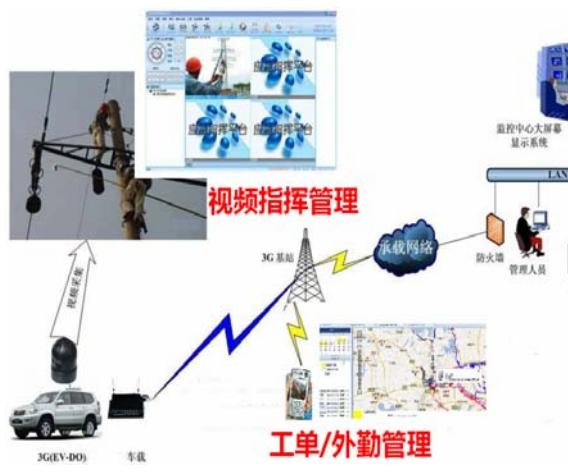
图 1 数字化配网抢修管理系统架构
